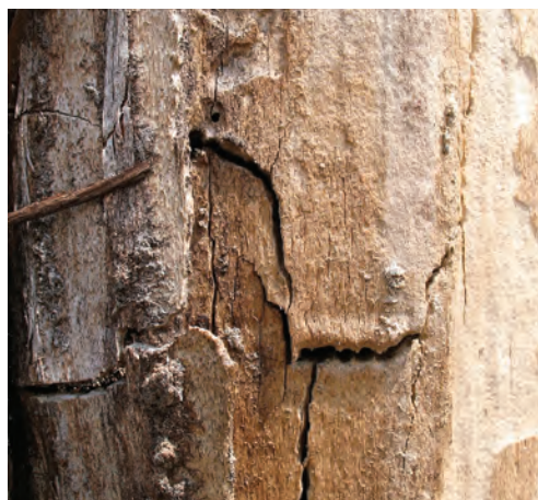
Fot. 98. Pod korą pnia drzewa płytka zgnilizna biała jednolita bielu
