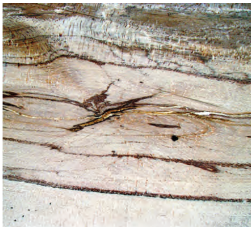
Fot. 59. Zgnilizna hubiaka zaczyna się w górnej części pnia i rozszerza w dół, tworząc żyłkowate przerosty ciemnobrunatną lub czarną grzybnią
